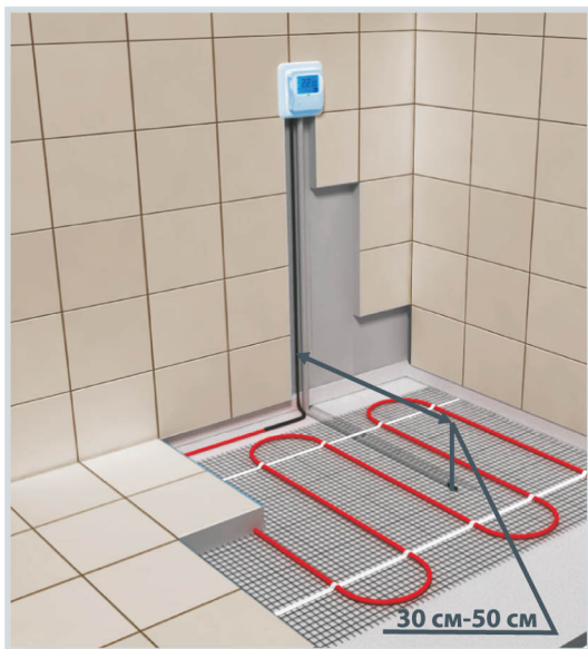
Схема укладки датчика температуры в гофрированной трубке
