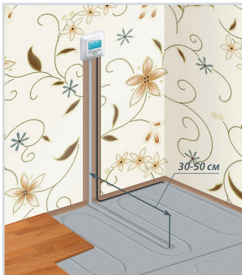
Схема укладки датчика температуры в гофрированной трубке
